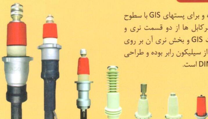
سرکابل های Connex Plug-in ساخت شرکت UE/GCA بوده و برای پستهای GIS با سطوح ولتاژ ۱۵ الی ۲۳۰ کیلوولت طراحی و ساخته می شوند. این سرکابل ها از دو قسمت نری و مادگی تشکیل شده اند. بطوریکه بخش مادگی آن بروی پست GIS و بخش نری آن بر روی کابل نصب می گردد. جنس عایق استفاده شده در سرکابل فوق از سیلیکون رابر بوده و طراحی اینگونه سرکابل ها بر اساس استاندارد DIN47637 و DIN47437 است.
